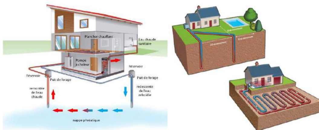
Figure 53 : Schéma de principe des différents types de géothermie de surface : géothermie sur aquifère ou géothermie sèche verticale ou horizontale.
